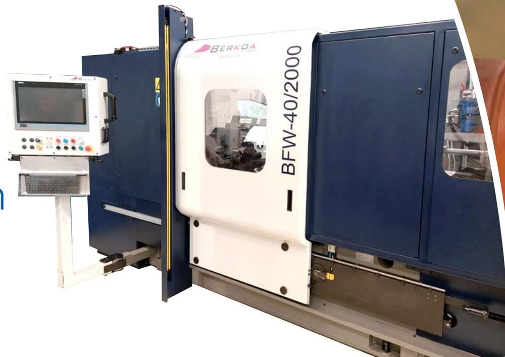
En collaboration avec Berkoa, une société coopérative d'Elgoibar spécialisée dans la conception et la fabrication de machines-outils spéciales, une machine à souder a été fabriquée et intégrée en utilisant la technologie du soudage par friction rotative pour la fabrication d'outils de petite et de grande taille.
